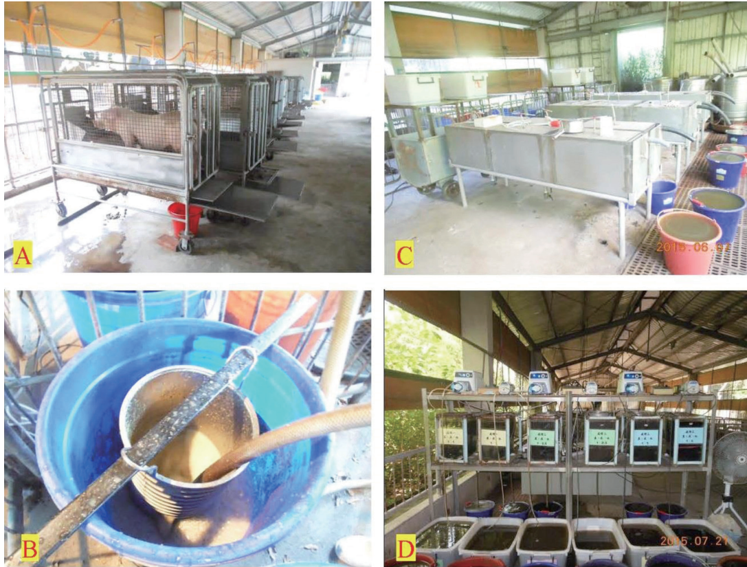
圖 1. 廢水處理流程。A：糞尿收集；B：固液分離；C：厭氧處理；D：好氣處理。
